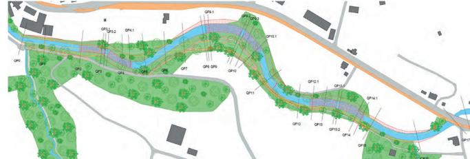
Das Konzept der dritten Variante besteht darin, die Gerinnesohlenbreite zu erhöhen und dem Fluss wieder eine natürlichere Morphologie zu verleihen. Um Erosion zu verhindern, wurde das Gesamtgefälle der Flussstrecke durch den Einbau von drei Blockrampen verringert, um die Veränderung des Gefälles auszugleichen.
