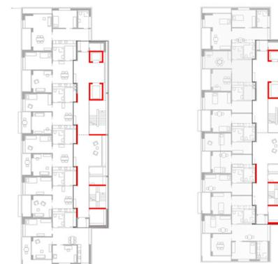
Abbildung 4: Alle durchlaufenden Wände (rot)
