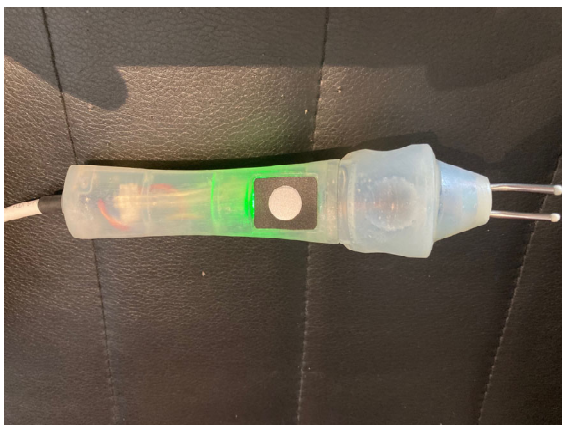
Abbildung 1: Bild des Gerätekopfes mit Elektroden und Startknopf. Alle Teile wurden im Haus 3D-gedruckt.
