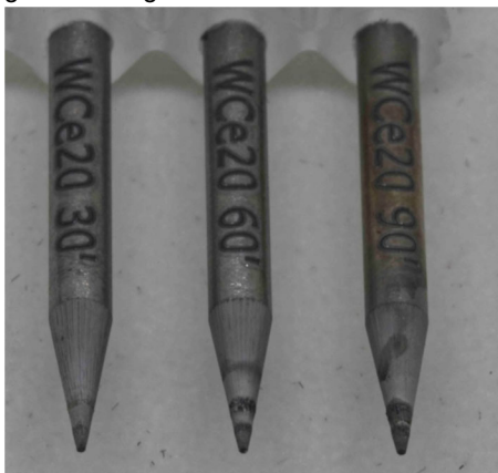
Abbildung 1: Von links nach rechts TIG-Schweißelektroden nach 30, 60 sowie 90 Minuten Einsatzzeit. Deutlich sichtbar sind die Oxidationsspuren an der Elektrodenspitze.
