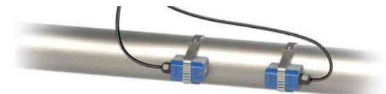
Abb. 3: Der Ultraschall-Durchflussmesser ermittelt die Fließgeschwindigkeit von Heizungswasser in einer Rohrleitung, ohne dass diese dazu aufgetrennt werden muss. Zusammen mit zwei Temperaturmesspunkten kann man dann den in den Leitungen transportierten Wärmestrom bestimmen.
