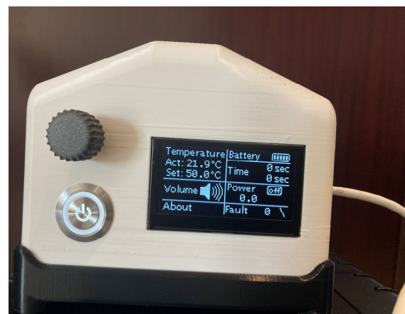
Abbildung 2: Abbildung der Basisstation des Geräts. Die Benutzeroberfläche besteht lediglich aus einem Drehgeber, einer Starttaste und einem OLED-Display.
