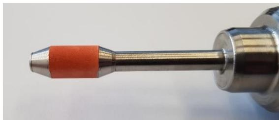
Abbildung 1: Resonator mit Verschmutzungsmodell (Kupferablagerung).
