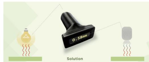
Fig. 2: Prototyp mit Illustration des Messvorgangs. Links wird Infrarotlicht in die Beschichtung gestrahlt und rechts die reflektierte Infrarotstrahlung detektiert. Diese wird der Schichtdicke zugeordnet, welche mittels Display ausgegeben wird.
