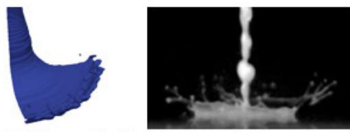
Fig. 2: Simuliertes und experimentell ermitteltes Auftreffverhalten.
