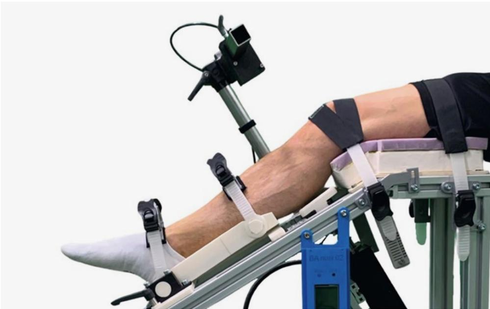
1 Das Knielaxizitäts-Messgerät mit dem eingespannten Bein eines Probanden.
