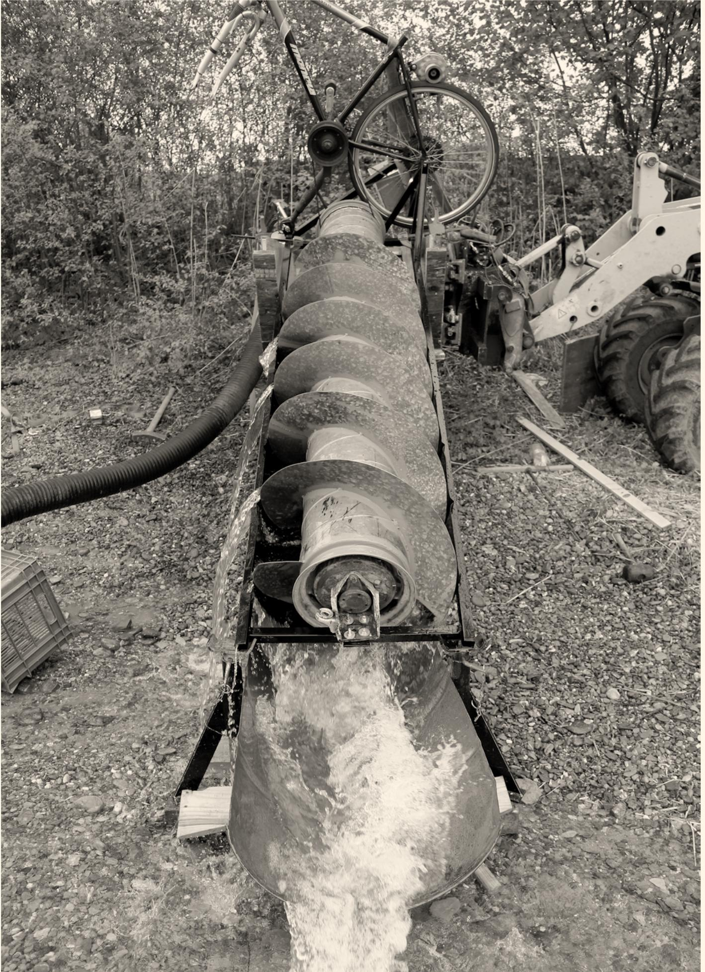
Mithilfe eines Velos und Metallschrott haben Robin Vetterli und Fabian Mohnen ein kleines Wasserkraftwerk konstruiert.
