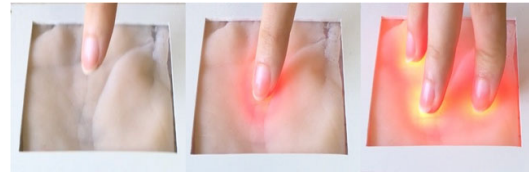
Abb. 2: Illustrationen der taktilen Fähigkeiten des künstlichen Hautmodells, das die reale menschliche Textur und die mechanischen Eigenschaften sowie die Farbveränderung in Abhängigkeit von der angewandten Kraft und der kapazitiven Mehrpunktsensorik implementiert.
