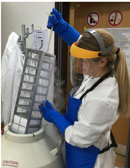
Abb.13: Nötige Schutz-ausrüstung bei den Arbeiten mit LN-Tank.
