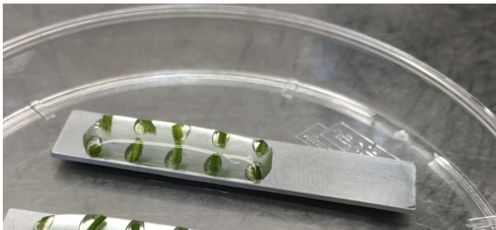
Abb. 10: Aluminium-Cryo-Plates überdeckt mit Calcium-Lösung für die Polymerisation
