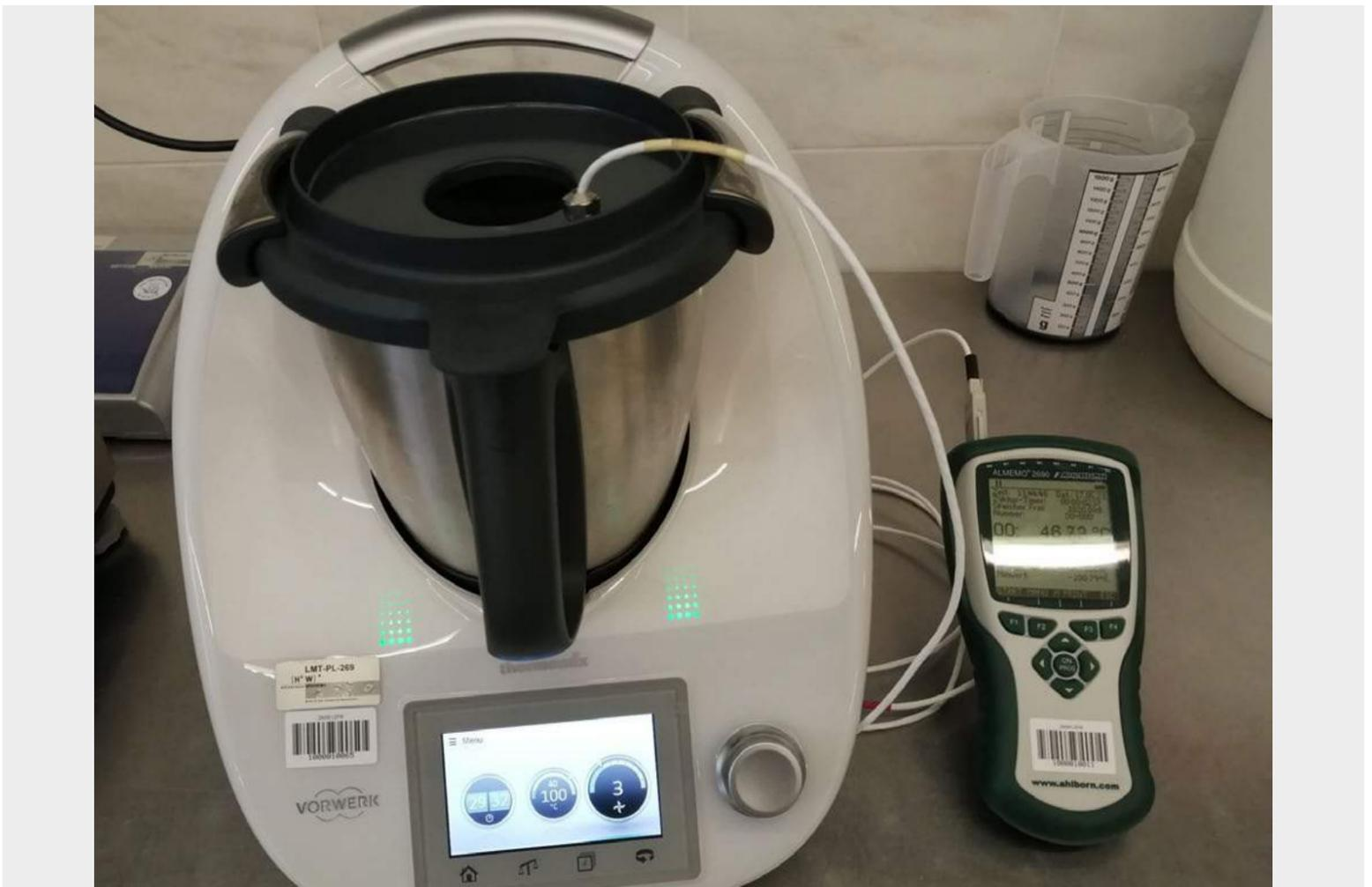
Abb. 1: Versuchsaufbau der konventionellen Erhitzung im Thermomix mit externer Temperaturerfassung
