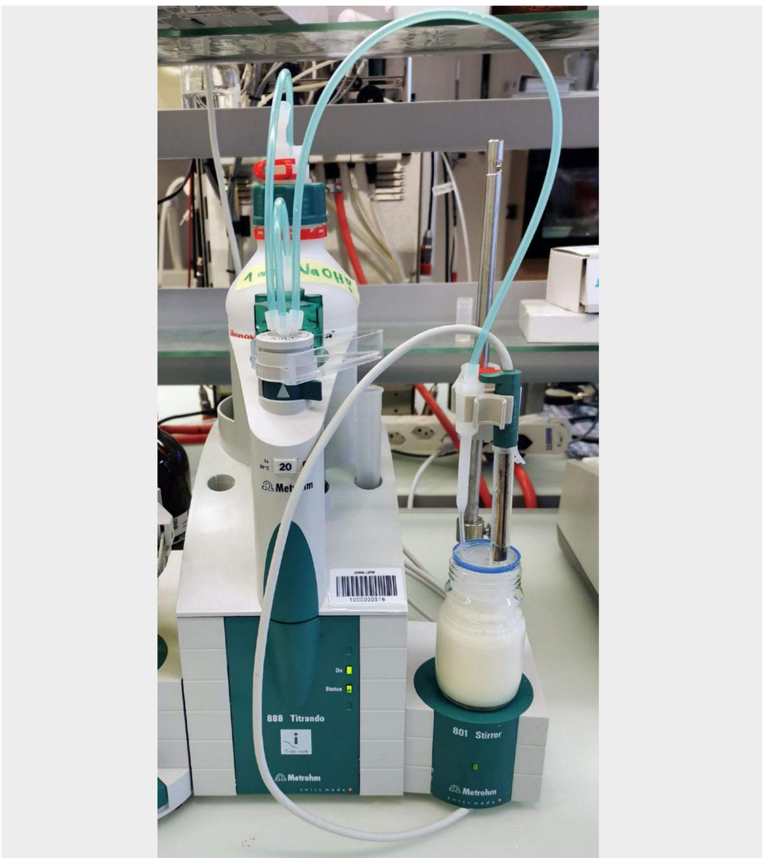
Abb. 1: Messung der Stoffwechselaktivität über Säuregrad und pH-Messung
