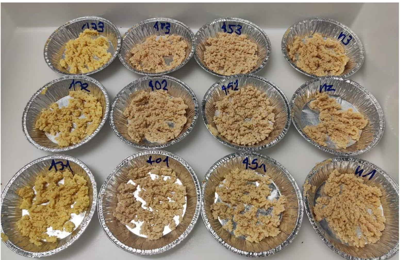
Abb. 1: Zur Bestimmung des Feuchtegehalts werden die fermentierten Hülsenfruchtmehle in Schalen in einem Trockenschrank getrocknet
