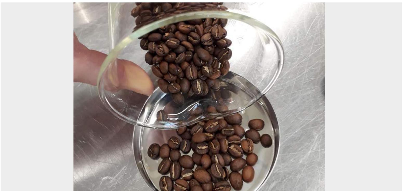
Abb. 4: Kaffeeproben einfüllen in Messschale für die NIRS
