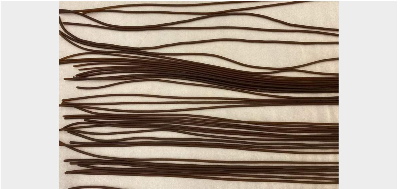
Abb. 3: Aus Kartoffelschalen und Additiven hergestellte Filamente, welche zur Folienherstellung genutzt wurden
