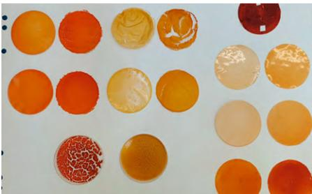
Abb. 1: Biopolymerfolien aus Tomatentrester, Tomatenhäuten und ganzen Tomaten in verschiedenen Konzentrationen und Zusammensetzungen
