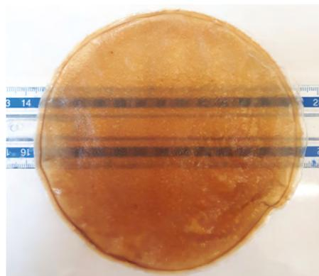
Abb. 1: Gliadinfolie nach dem Aushärten bei 85 °C
