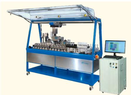
Abb. 1: Verwendete Anlage – Chemspeed Technologies Emulsifier
