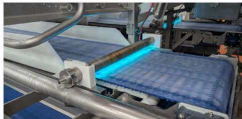
Abb. 2: Praktische Anwendung von UV-C-Lampen auf einem Gliederband in der Produktion
