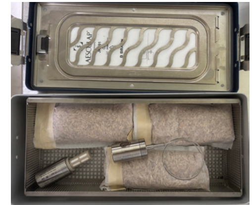
Abb. 1: Kleine Sterilbox, in der die Hitzebehandlung durchgeführt wurde, sowie Proben und die verwendeten Datenlogger zur Temperatur- und Feuchtigkeitsaufzeichnung
