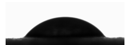
Abb. 2: Wasserkontaktwinkel einer Folienprobe mit SiOx-Beschichtung (WCA < 45°)
