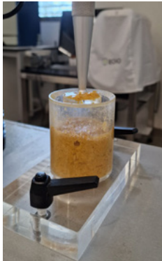
Abb. 1: Texturanalyse eines entwickelten Gerichts mittels Texture Analyser
