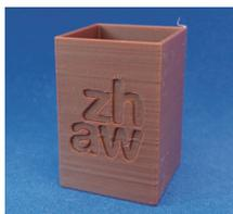
Abb. 2: 3D gedrucktes Anschauungsmaterial mit einem biocompoundierten PLA-Filament; 7,5 % Kakaobohnenschalen-Anteil im Filament
