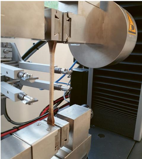
Abb. 1: Spritzgegossener Prüfkörper aus einer PBAT/Kartoffelschalen-Mischung während des Zugversuches zur Ermittlung der mechanischen Eigenschaften
