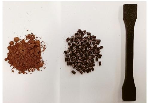
Abb. 1: Kakaobohnenschalen getrocknet und gemahlen, Pellets aus Biopolymer und Kakaobohnenschalen und spritzgegossener Prüfkörper aus den Pellets (v. l. n. r.)
