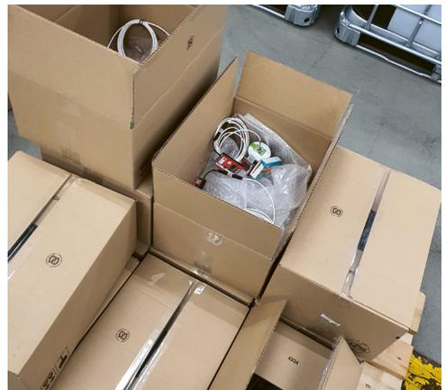
Abb. 2: Aufbau der Versuchspalette mit Produktproben in drei Schichten verteilt
