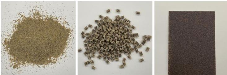
Abb. 1: Rapspresskuchen in den einzelnen Verarbeitungsstufen (v.l.n.r.: getrocknet und zerkleinert ( $<355 \mu\text{m}$ ), extrudierte Pellets, extrudierte Folie)
