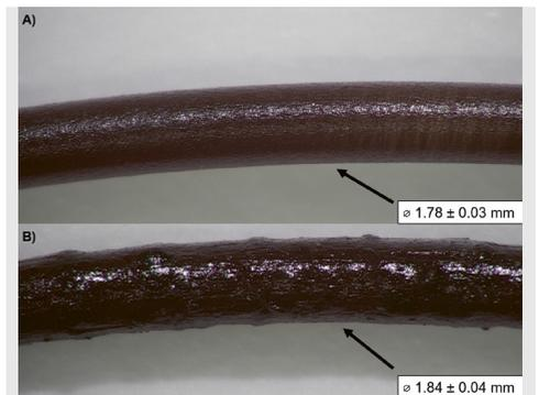
Abb. 1: A) Biocompound-Filament, 7,5 % Kakaobohnenschalen + 92,5 % PLA; B) Biocompound-Filament, 10 % Kakaobohnenschalen + 90 % PLA
