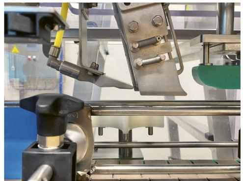
Abb. 2: Unterdeckelbegasungseinheit des Dosenverschliessers
