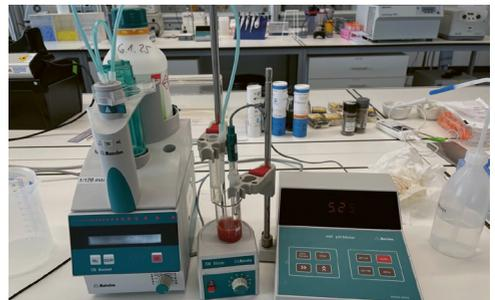
Abb. 2: Messung des Zitronensäuregehalts mittels Dosimat und pH-Messgerät
