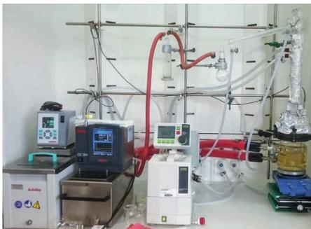
Abb. 2: Versuchsaufbau: Die Reaktion wurde in einem 500 mL-Doppelmantelreaktor durchgeführt. Darüber wurde ein beheizbarer Kühler montiert, welcher es erlaubt, das Reaktionswasser abzutrennen und gleichzeitig aufsteigende, flüchtige Edukte zu kondensieren und in die Reaktionslösung zurückzuführen.
