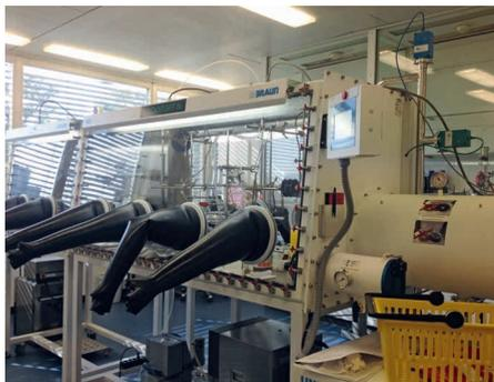
Abb.: Die Herstellung der Eisen-Katalysatoren erfolgte grösstenteils in der Glovebox.
