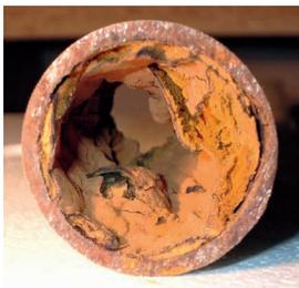
Abb. 1: Eine durch Biofilm beschädigte Wasserleitung.
