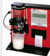
Abb. 2: links: Vergleich des Zeta-Potentials von verschiedenen Handschichten zwischen pH 2 und 10; rechts: Mütek SZP-06, Gerät zur Bestimmung des Zetapotentials von Filterschichten und Filterhilfsmitteln
