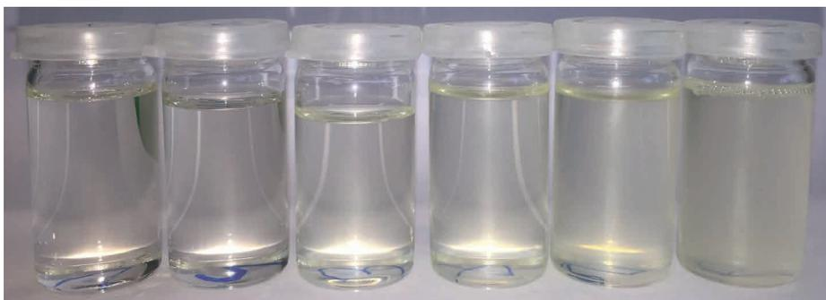
Diese Abbildung zeigt Muster des Fettsäureesters mit den Trübungswerten 0,00, 5,27, 11,68, 20,0, 45,4 und 290 NTU (v.l.). Das Muster ganz rechts zeigt das Ausgangsprodukt, ganz links ist das filtrierte Produkt zu sehen.
