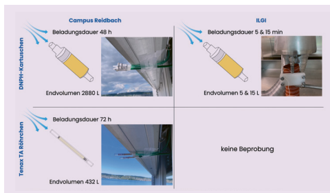
Abb. 1: Übersicht der Luftbeprobungen am Campus Reidbach und am ILGI. Dargestellt sind die eingesetzten Beprobungsröhrchen, die jeweilige Beladungsdauer und das gesammelte Endvolumen. DNPH-Kartuschen wurden an beiden Standorten eingesetzt, während Tenax-TA-Röhrchen am Campus Reidbach für die Aussenluft-Beprobungen verwendet wurden.
