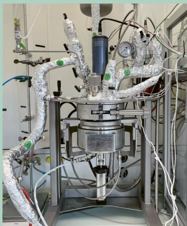
Abb. 1: Midiclave-3E-Reaktor zur Hydrierung von Benzophenon
