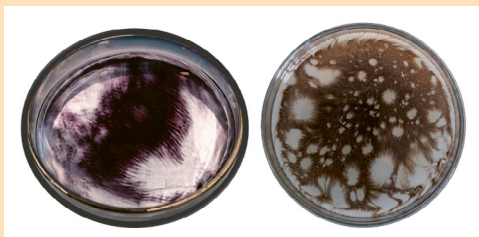
Abb. 1: Durch Sputtering-onto-Liquid hergestellte Nanopartikel, links: Gold; rechts: Palladium
