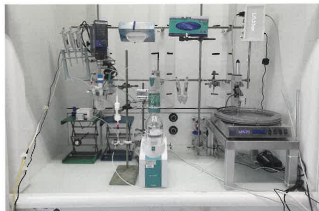
Abbildung 3: Fotografie des Aufbaus für die kontinuierliche Prozessführung im Labor
