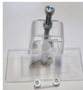
Abb. 1: Replikationssystem für nanostrukturierte Oberflächen aufgenommen während dem Replikationsprozess eines Zikadenflügels.
