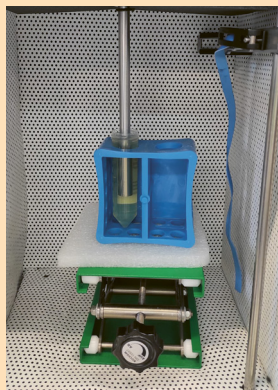
Abb. 1: Der Messaufbau für eine HP5-Medium-Messung mit der Messlanze am Timegated PicoRaman M3.
