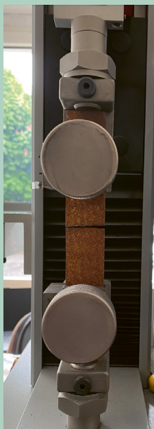
Abb. 2: Zugversuchsmaschine zur Bestimmung der Elastizität und Reissfestigkeit des Tabakpapiers.
