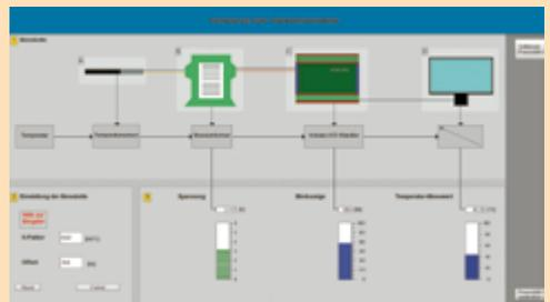
Abb. 1: Prozessleitbild «Kalibrierung einer Temperaturmesskette».
