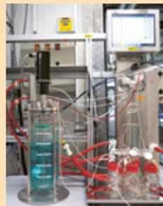
Abb. 2: Der für die Fermentation der Hefezellen verwendete Bioreaktor. Während der Batch- und Feedingphase wurden der pH-Wert, der Sauerstoffgehalt, die Temperatur sowie die Rührerdrehzahl des Reaktors kontinuierlich überwacht. Die Probenahmen erfolgten vollautomatisch.
