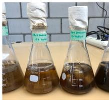
Abb. 2: Erlenmeyerkolben mit Pilzkultur und verdünntem Prozesswasser für den Wachstumsversuch.
