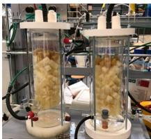
Abb. 1: Entwickelte Reaktorsysteme mit Trägermaterial.
