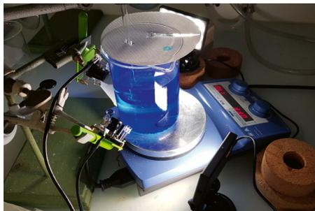
Abb. 1: Beispiel für einen einfachen Versuchsaufbau zwecks Tests verschiedener Kamerabefestigungen und -positionen.
