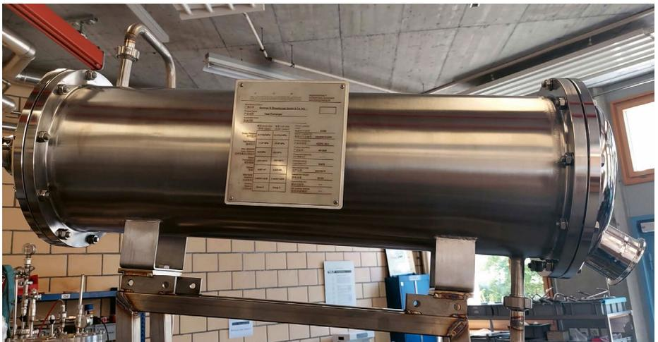
Abb. 1: Der ausgelegte Wärmeüberträger. Von unten rechts strömt die Abluft durch den Wärmeüberträger und verlässt diesen auf der linken Seite. Das Kühlmedium fliesst im Gleichstrom von unten rechts nach oben links.
