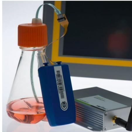
Abb. 1: Glucose-Biosensor der Firma C-CIT AG integriert im Deckel des Schüttelkolbens. In Blau ist der Bio-Beamer ersichtlich, der mit dem Sensor verbunden ist (C-CIT Sensors AG, 2015).
