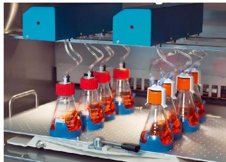
Abb. 1: Kultivierung mit der KuhnerTOM-Messvorrichtung; Quelle: [www.kuhner.com](http://www.kuhner.com).
