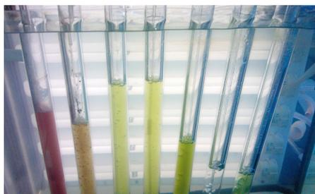
Photobioreaktoren im Labormasstab (d.h. beleuchtete, mit durch CO<sub>2</sub>-angereicherte Luft begaste Glasröhren mit Mikroalgen-Suspension)
