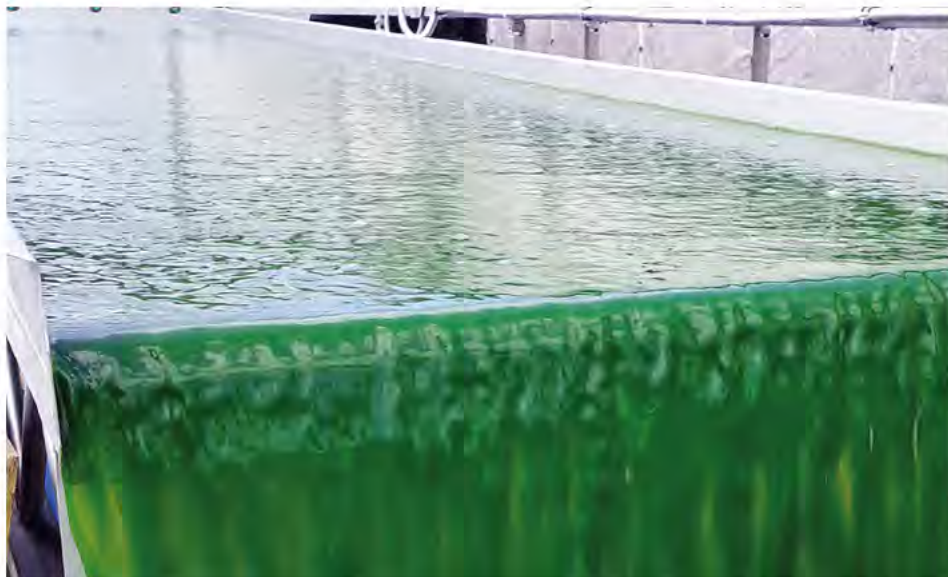
Kurz vor der Ernte kann die Grünalge Chlorella vulgaris nahezu 50% des Flüssigkeitsvolumens ausmachen, was ungefähr zehn Kilogramm trockener Biomasse entspricht. (Bild: Dominik Refardt)
