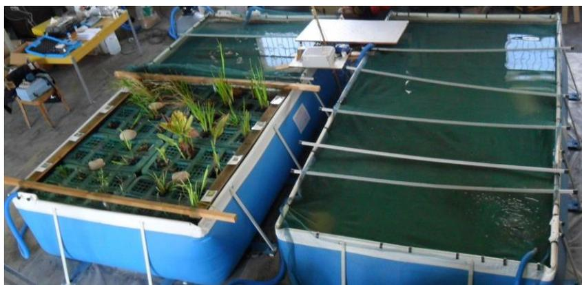
Figure 6 : installation pilote interne pour la reproduction des carpes, avec et sans structures Tech-IA (Florio et al. 2014).
