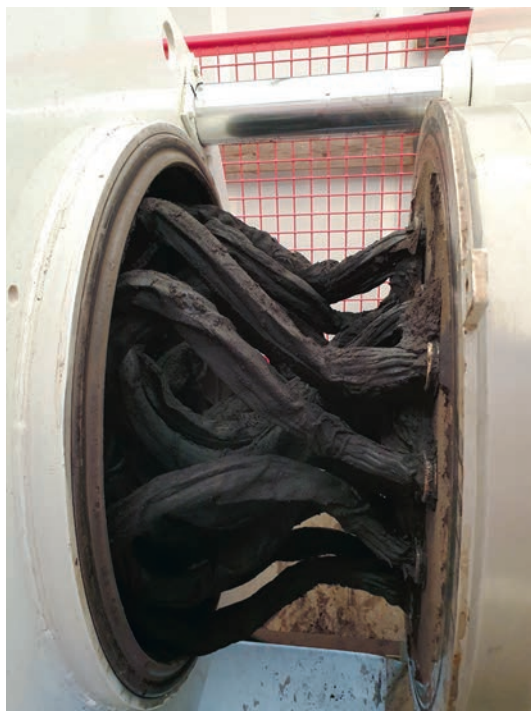
Entwässerung von Kohleschlamm mittels hydraulischer Filterpresse der Firma Bucher Unipektin.
