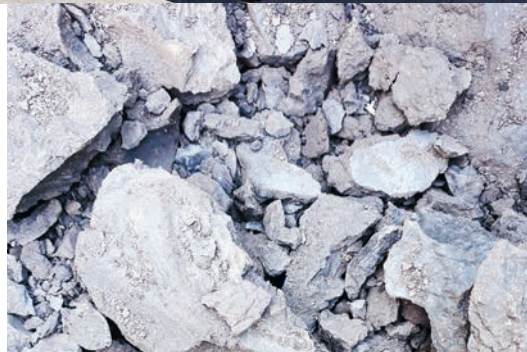
Betriebsgebäude der HTC-Pilotanlage der Firma GRegio Energie AG in Chur (grosses Bild). HTC-Kohle aus Klärschlamm nach Filterpressung (kleines Bild).
