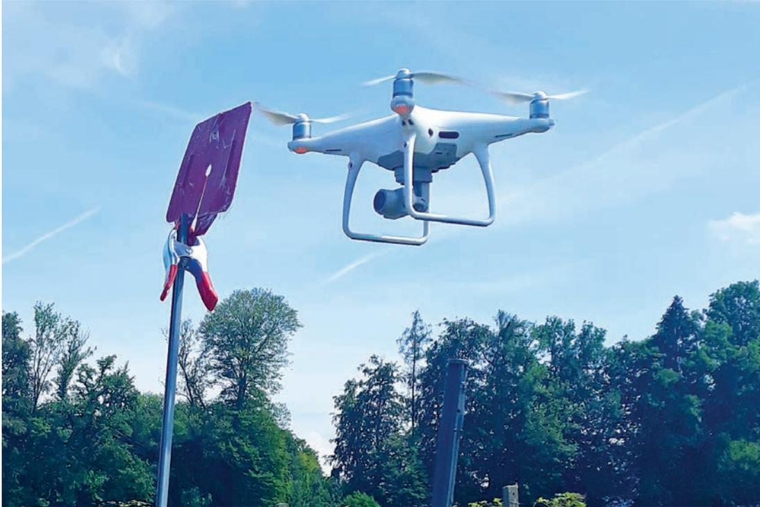
Drohne DJI Phantom 4 pro macht ein Bild von einer Klebefalle. Die Distanz von Drohne zu Falle sollte nicht grösser als 50 cm sein. Die Versuche an der ZHAW werden in Zusammenarbeit mit Johann Junghardt, Forschungsgruppe Geoinformatik, gemacht.
