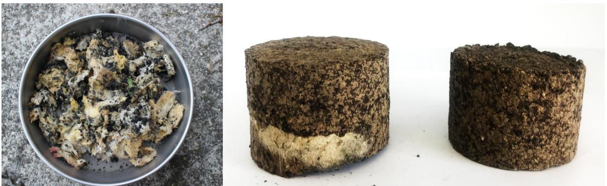
Abbildung 9. Methodisches Vorgehen für die Analyse der Dachsubstrate mit organischer Schicht. Links: Nicht degradierte Schafswolle wurde aus dem Substratproben abgetrennt und im Labor mittels Siebs vom Feinanteil getrennt. Rechts: Laborverdichtete Substratproben, wobei die links die Wolle mittig eingeführt wurde (Fotos: C. Winter, 2021).
