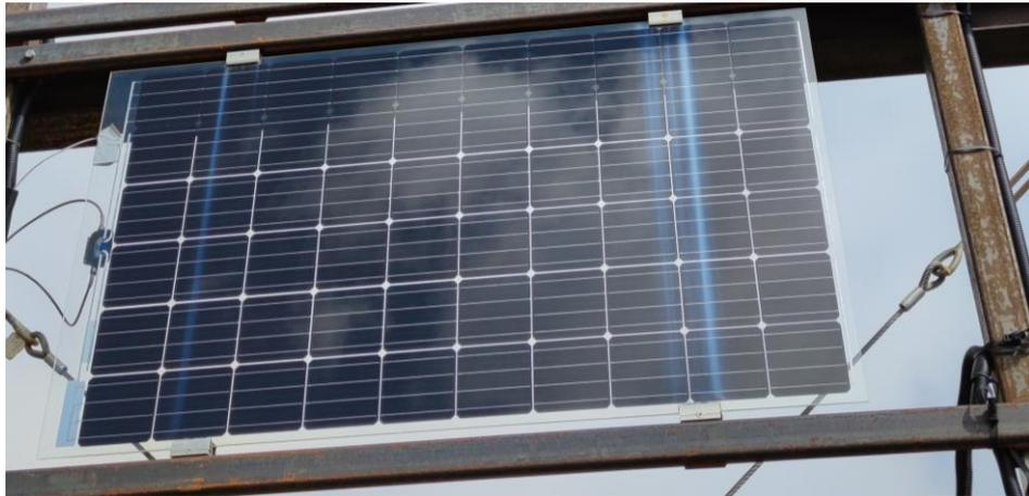
*Abbildung 21: Ablagerungen auf den PV-Modulen im Segment 90° bifazial. Vermutlich entstanden durch eine Abtropfkante der Stahlkonstruktion und den Modulklemmen.*
