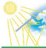
Beim 360° Bifacial Glas-Modul von PVP wird das Licht sowohl auf der Vorder- als auch auf der Rückseite des Moduls aufgenommen. Die erhöhte Lichtausbeute steigert den Wirkungsgrad des Moduls. Über die aktive Modulrückseite können so bis zu **360 Wp Gesamtleistung** erzielt werden (Bsp. 285 Wp Modul Front / 330-360 Wp durch 360° Einstrahlung).
