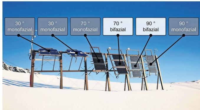
**Winkel.** Alpine Photovoltaik-Testanlage Davos Total mit den verschiedenen Neigungswinkeln und Modultechnologien (mono- und bifazial) pro Anlagensegment. Bei den bifazialen Segmenten wird eine Verschattung der Rückseite durch das Montagesystem weitestgehend minimiert.
