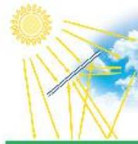
Beim 360° Bifacial Glas-Modul von PVP wird das Licht sowohl auf der Vorder- als auch auf der Rückseite des Moduls aufgenommen. Die erhöhte Lichtausbeute steigert den Wirkungsgrad des Moduls. Über die aktive Modulrückseite können so bis zu 360 Wp Gesamtleistung erzielt werden (Bsp. 285 Wp Modul Front / 380-360 Wp durch 360° Einstrahlung).
