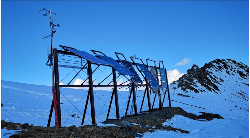
Abbildung 22: Neigungswinkel der Alpinen Versuchsanlage ab 01.Oktober 2020. Die Segmente B, C und D wurden umgestellt.
