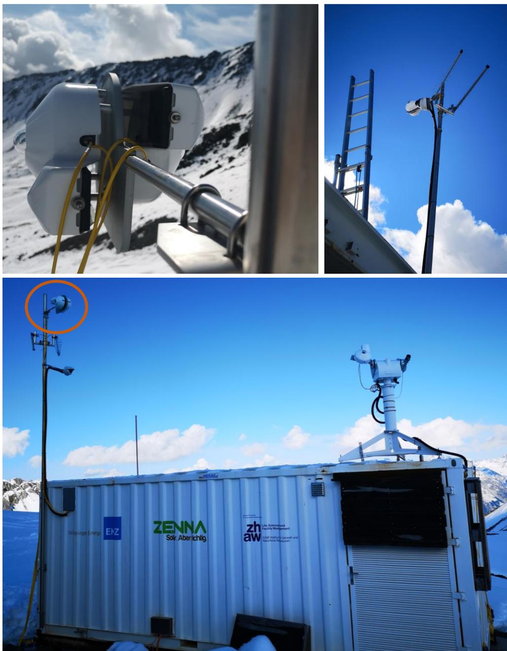
Abbildung 23: Zusätzliche Einstrahlungsmessung (Globalstrahlung) vertikal aus östlicher und westlicher Richtung ab 01. Oktober 2020. Ost-West-Montage der Einstrahlungssensoren am Messmasten des Messcontainers oben links. Messmasten mit Antenne, Webcam und Einstrahlungssensoren oben rechts. Gesamtansicht des Containers mit den neuen Einstrahlungssensoren unten.
