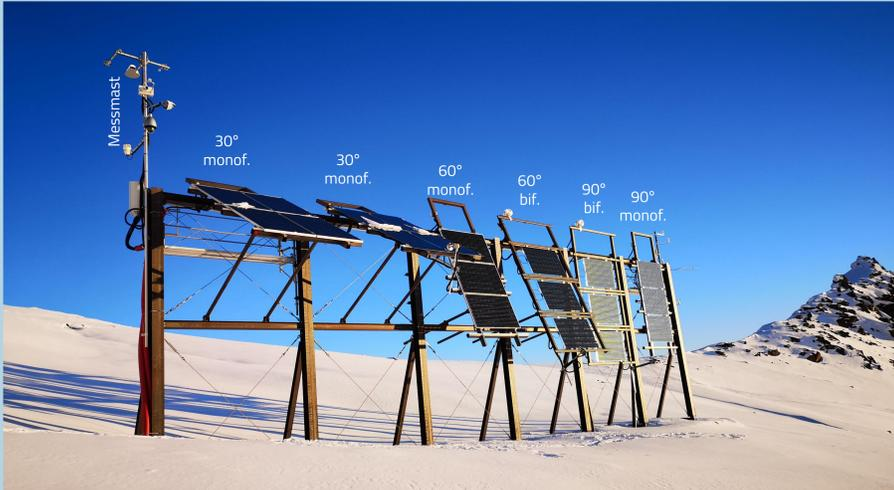
Abbildung 1: Alpine Photovoltaik-Versuchsanlage Davos Totalp. Die Anlage verfügt über sechs nach Süden ausgerichtete Anlagensegmente mit 30, 60 und 90° geneigten mono- und bifazialen Modulen. Jedes Modul ist mit einem Optimierer ausgerüstet und wird DC-seitig an einem separaten Energiemeter ausgemessen. Daneben werden die Wetterbedingungen kontinuierlich erfasst. Zusätzlich wird die Einstrahlung in unterschiedlichen Ebenen gemessen.
