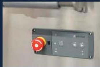
Kontroll-Panel für Antrieb mit Not-Aus-Schalter Panneau de contrôle de l'entraînement avec interrupteur d'arrêt d'urgence
