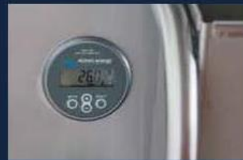
Akku-System Anzeige der Ladestände auf einem Indisplay Système de batteries affichage du niveau de charge sur un écran d'information
