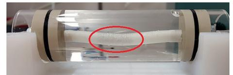
Abb. 3: Die Kammer, welche im IMES bei Prof. Dr. Daniel Baumgartner entwickelt wurde, erlaubt unter anderem die Einführung eines Stents in das konstruierte Gefäss
