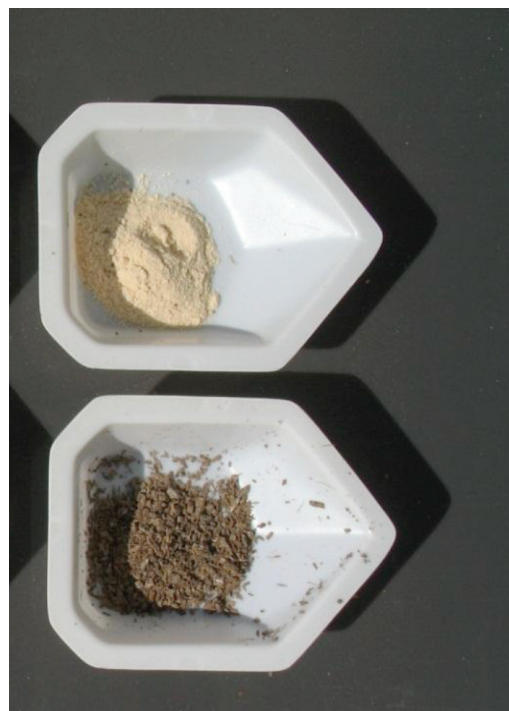
Proben von Enzymprodukten und Zusätzen, die zur Vorbehandlung von Substraten eingesetzt werden, um die Vergärung zu intensivieren und damit den Energieertrag zu erhöhen. Foto: Schlussbericht 2012 'Massnahmen zur Optimierung der Vergärung'
