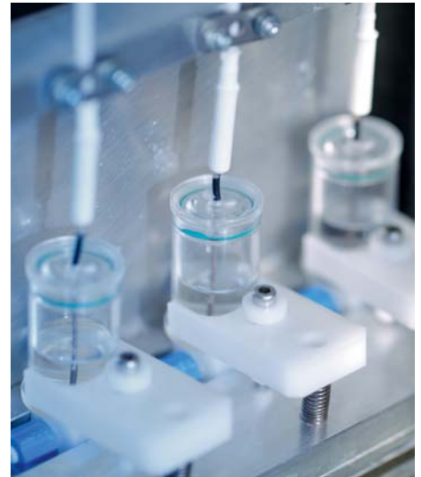
Automatisiertes Durchflusssystem für die gleichzeitige Analyse von Blutelektrolyten.
