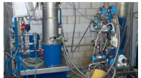
20-Liter-Labor-Membranbioreaktor der Fachgruppe Umweltbiotechnologie an der ZHAW.
