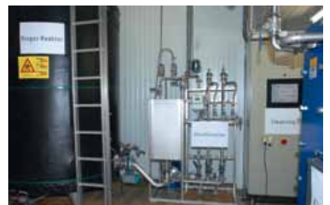
2000-Liter-Pilot-Membranbioreaktor an der Agroscope in Tänikon (ART).
