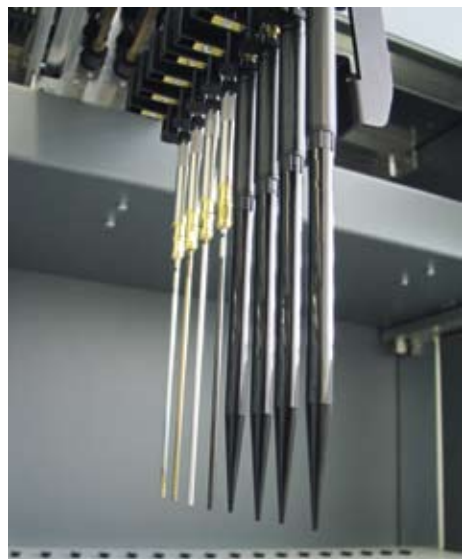
Beschichtete Pipettiernadeln (hinten) und Disposable Tips (vorne) integriert an einem Roboterarm.
