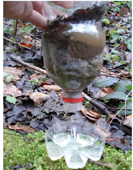
Abb. 9: Wasserfilter aus PET-Flasche
