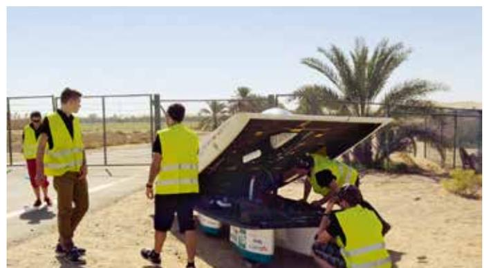
Taktischer Boxenstopp in der Wüste: Um die Batterie optimal zu laden, wird das Solarpanel gegen die Sonne ausgerichtet.
