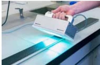
Das Skiwachs wird mittels UV-Licht einer Quecksilberdampfampe bestrahlt.
