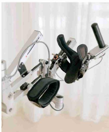
**Mit dem Armeo-Spring-Roboter wird das Strecken des Ellbogens trainiert.**
