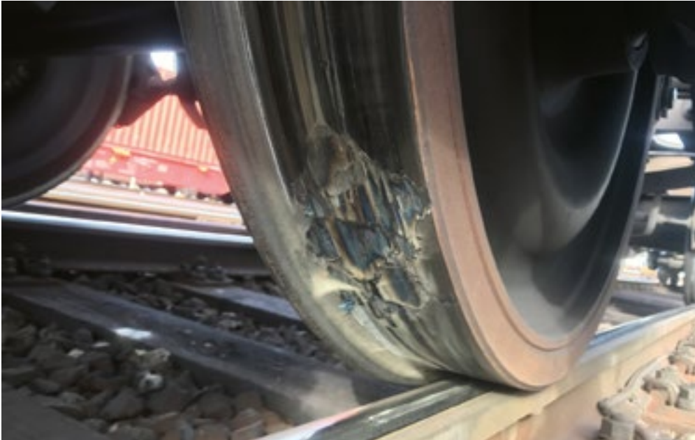
1 Das Bild zeigt beispielhaft eine Flachstelle an einem Zugrad.
