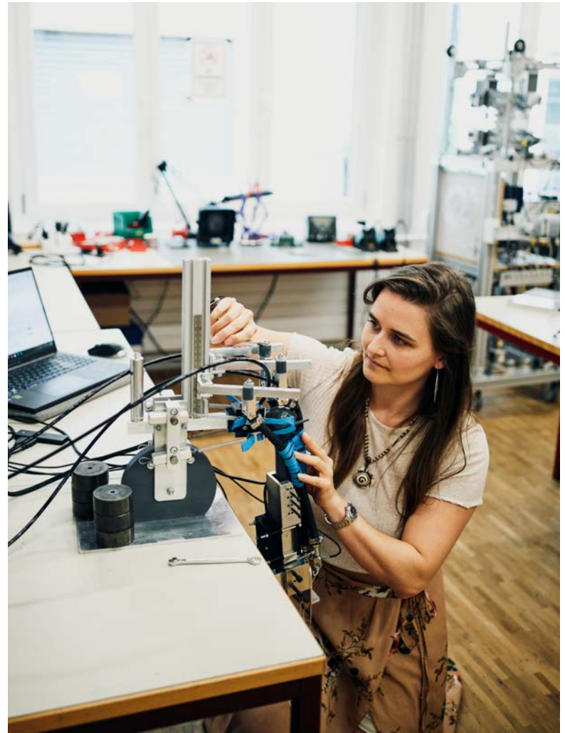
Mit luftgefüllten Muskeln simulierte Simona Züger die Mechanik einer menschlichen Schulter.
