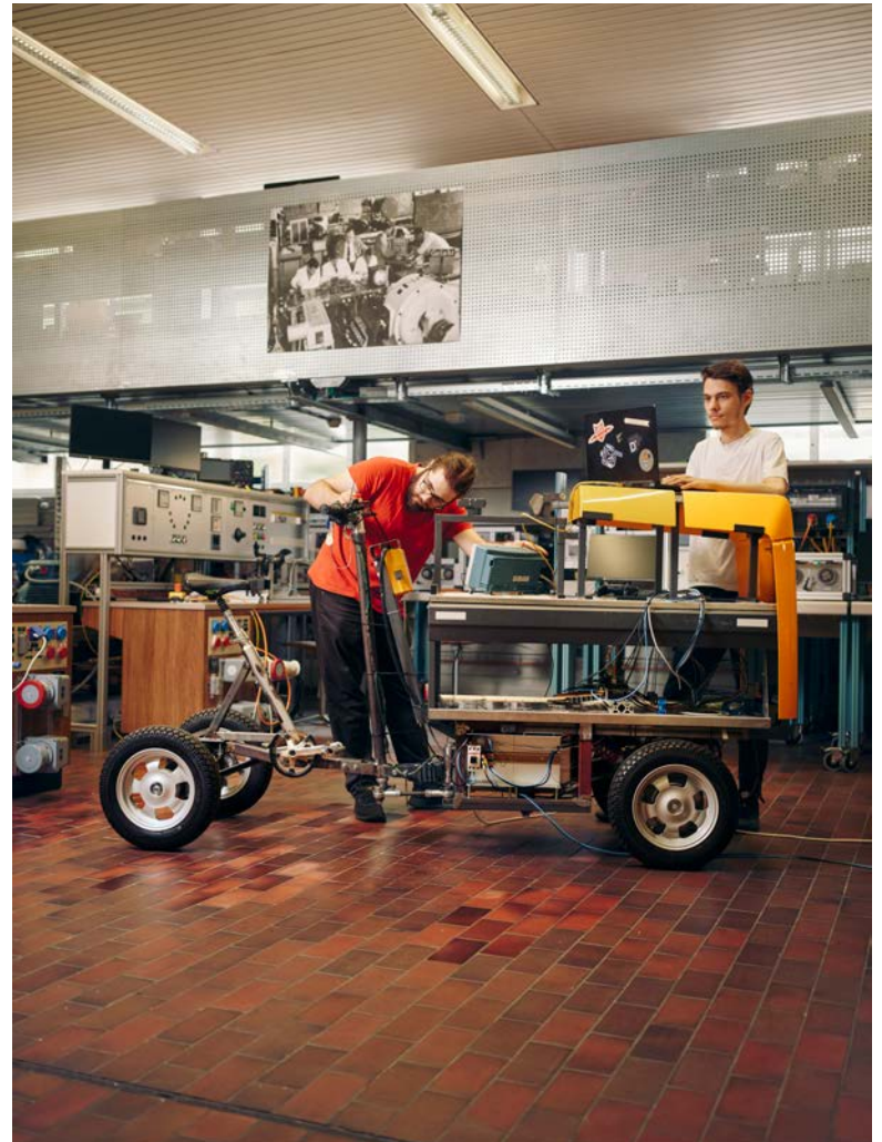
Zwei Elektromotoren helfen dem Kleintransporter von Fabian Luchsinger und Renato Gysi unterstützend bei der Lenkung.
