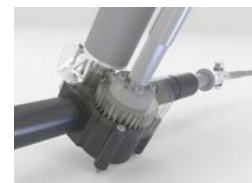
Das Herz der Lenkung: Das neu entwickelte Lenkgetriebe mit automatisierter Aktuierung im Detail.
