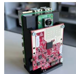
Der Demonstrator verfügt über eine 3D-Druck-Halterung mit Radar- und Kameramodul an der Vorderseite sowie einen Raspberry Pi 5 an der Rückseite.
