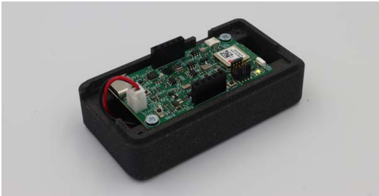
Die Sensorplattform passt ins dafür angefertigte Gehäuse. Der Akku liegt nicht sichtbar unter dem PCB.
