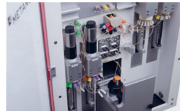
Das Analysegerät misst die Bakterienzahl mittels Durchflusszytometrie.
