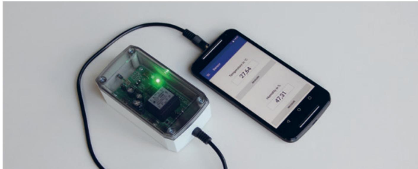
Der Headset-Stecker eines Smartphones dient normalerweise als Anschluss für die Kopfhörer. Die Elektrotechnik-Absolventen Tobias Grieder und Rico Jud beweisen in ihrer Bachelorarbeit, dass er auch für andere Anwendungen eingesetzt werden kann.
