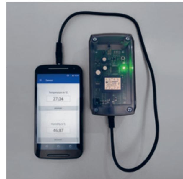
Der Sensor braucht keine eigene Batterie, sondern wird über den Headset-Stecker mit Strom versorgt.
