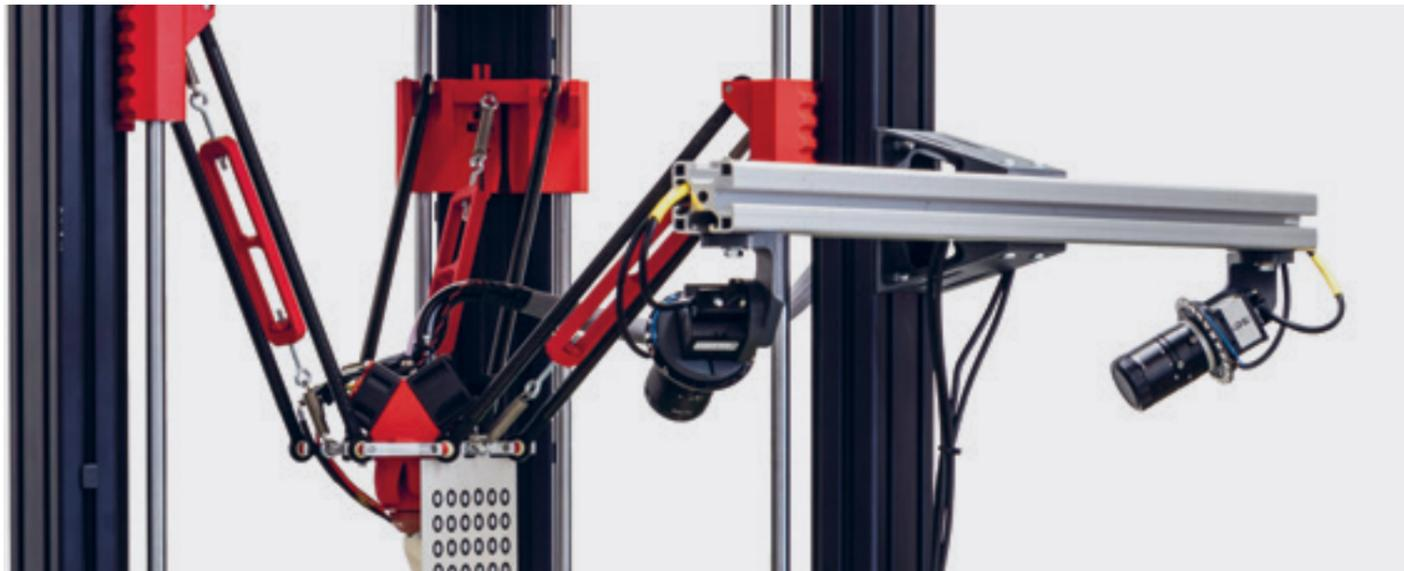
Im Rahmen seines Masterstudiums hat Oliver Tolar zunächst einen neuartigen Sechs-Achsen-3D-Drucker mitentwickelt. Dieser druckte bis anhin nicht genau genug. Als Masterarbeit hat er den 3D-Drucker nun mit einem optischen Kalibriersystem ausgestattet.
