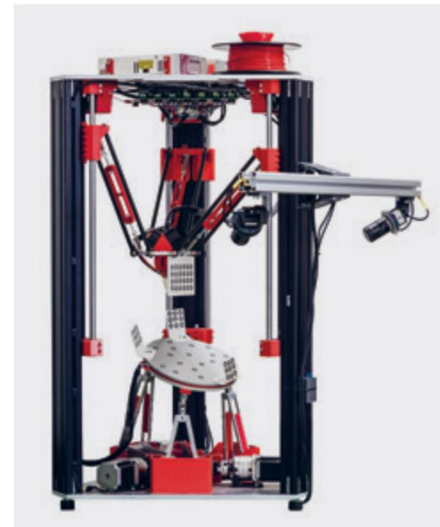
Der Sechs-Achsen-3D-Drucker ist neu mit Kameras und Reflexionsmarkern ausgerüstet.
