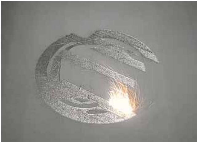
Abb. 4: Additive Fertigung eines Spritzgusswerkzeugs mit konturnaher Kühlung in Werkzeugstahl
