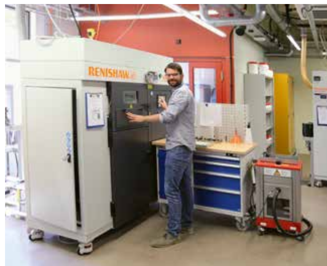
Patrik Hochreutener, Wissenschaftlicher Assistent, an einer der beiden im Einsatz befindlichen Drucker zum Selektiven Laserschmelzen (SLM) Renishaw AM400 HT (400 W Laser, 499°C Bauraumheizung), Renishaw AM250 (200 W Laser), Arbeitsraum: 250 × 250 × 320 mm, Schichtauflösung: 30 - 50 µm Werkstoffe: Edelstahl 1.4404 (316L); Werkzeugstahl 1.2709; Ti6Al4V; AlSi10Mg, weitere Materialien auf Anfrage.
