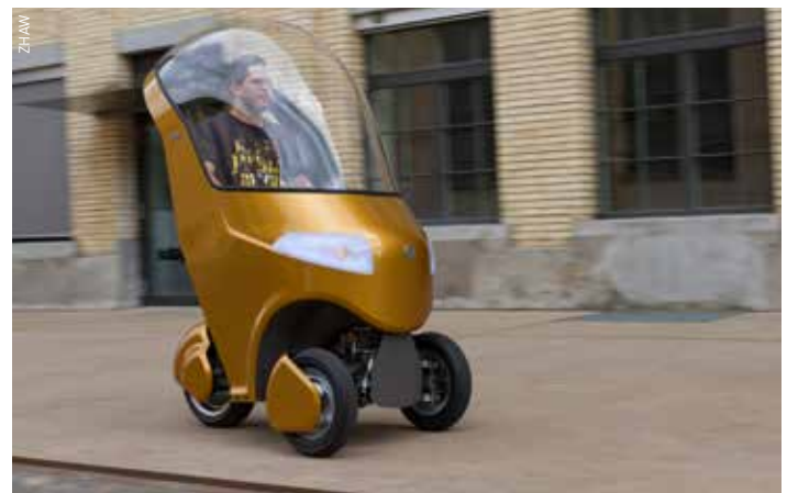
Der Bicar ist spezialisiert für den Nahverkehr in der Stadt. Hier der Prototyp der ZHAW.
