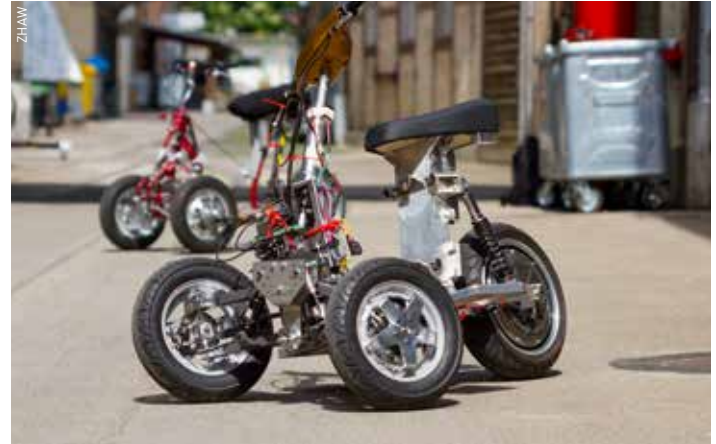
Der Prototyp ohne Verkleidung: Die Neigetechnik ist nun deutlich zu sehen.
