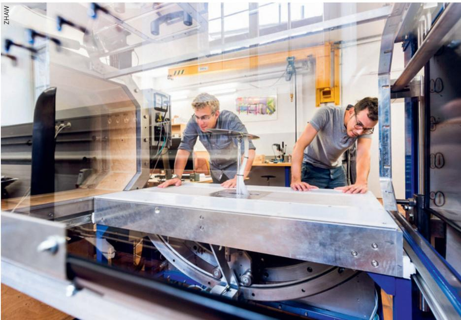
Studierende bereiten ein aerodynamisches Experiment im Windkanal der ZHAW vor.
