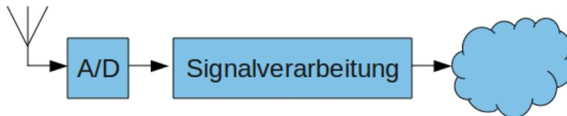
Abbildung 3.1.: Aufbau eines idealen SDR Empfängers
