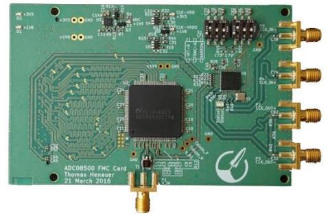
ADC für Multifrequenz-GNSS-Rx (BP-Sampling).
