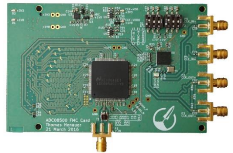
ADC für Multifrequenz-GNSS-Rx (BP-Sampling).
