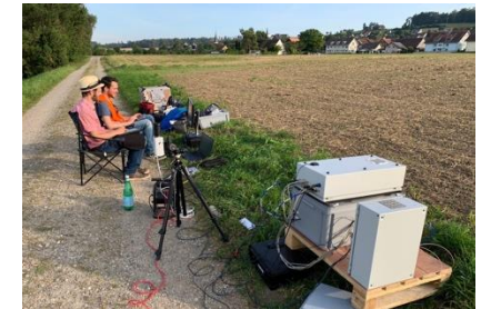
X-Band FMCW Bird-Radar (Feldtest, Innosuisse-Projekt )
