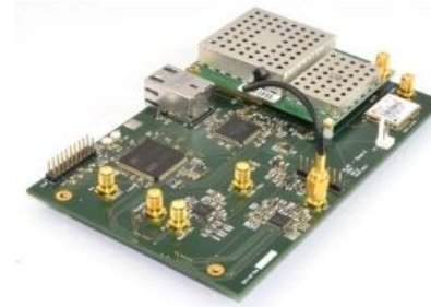
Avionik-Empfänger (ADS-B 1090 MHz, FLARM 868 MHz )
