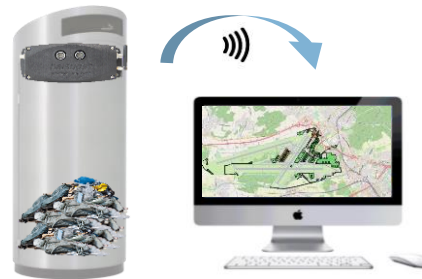
NB-IoT (Sensor und Connectivity Modul)
