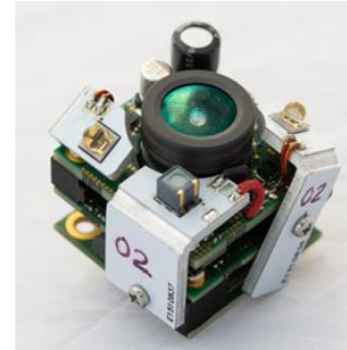
Optoelektronik (kleines 3D-ToF-Modul)
