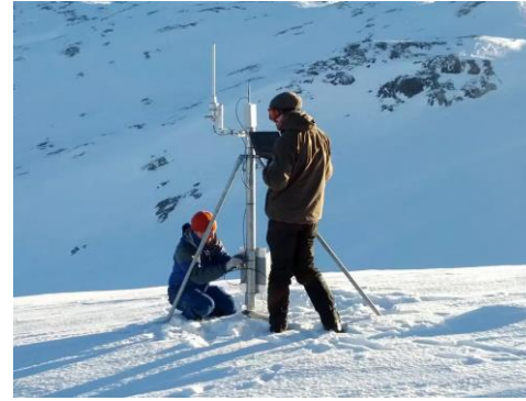
Redundantes Funksystem (Sub 1-GHz, Überwachung Naturgefahren)
