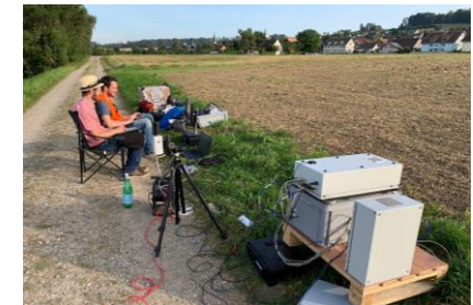
X-Band FMCW Bird-Radar (Feldtest, Innosuisse-Projekt )
