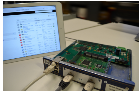
InES Regression Test System auf einem Embedded System. Das System ist über Ethernet mit einem lokalen Netzwerk verbunden und kann daher mit jedem internetfähigen Gerät gesteuert werden.
