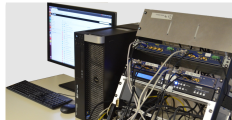
Ein PC basiertes Test System zum Testen von hochauflösender Video und Audio Übertragung über Ethernet. Das Test Environmetn auf dem PC simuliert dabei sämtliche Video Quellen und Senken sowie ein komplettes Ethernet Netzwerk.
